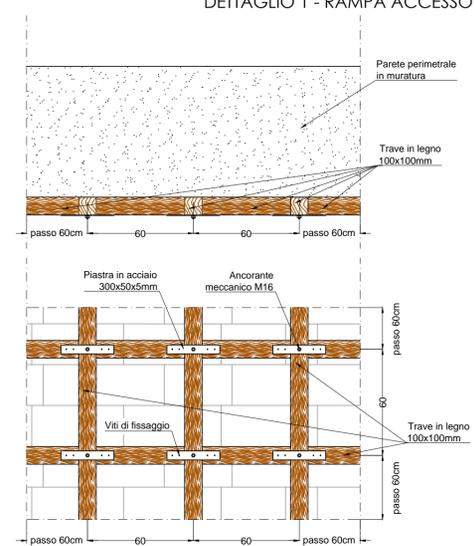
DETTAGLIO 4 - RINFORZO STRUTTURALE PARETI VOLTA
